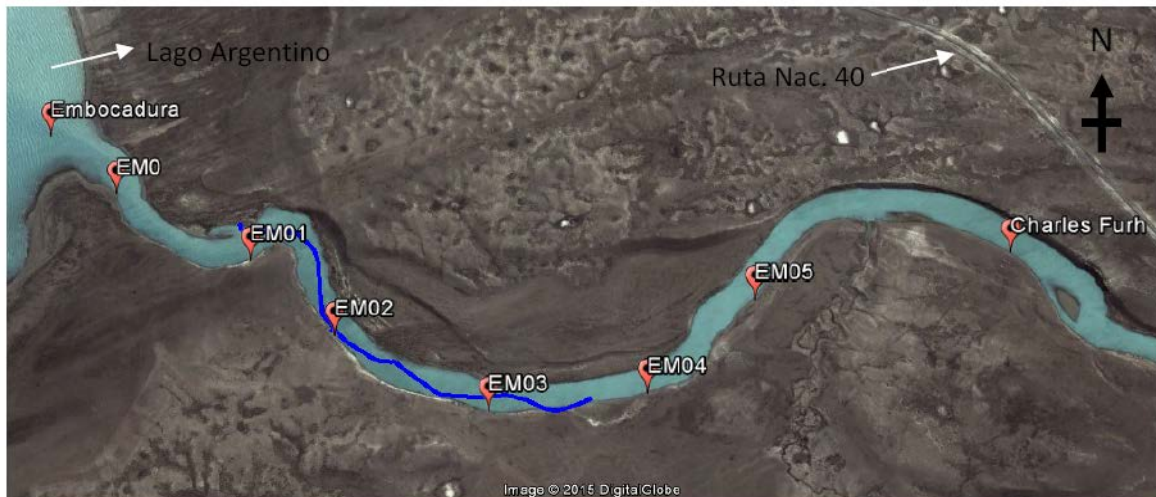
Estaciones de medida con relevamientos de niveles y velocidades del grupo CETA-UNC.
